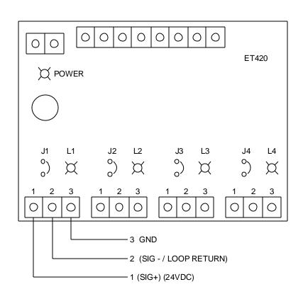
L1-L4: INDICATES CHANNEL STATUS L5: INDICATES POWER 'ON' J1-J4: LOOP EXCITATION JUMPER
